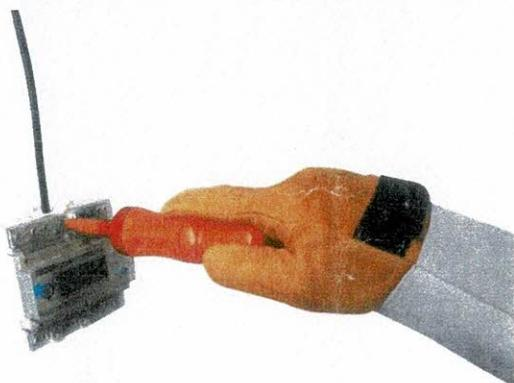
3. Serrage au couple 4.72Nm ( $\pm 6\%$  : 4.44 à 5 Nm) en position coudée ou droite.
